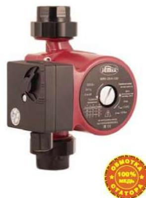
Циркуляционные насосы JEMIX серии WRS-32/x-130 предназначены для принудительной циркуляции теплоносителя\*\* внутри замкнутой системы отопления. Конструктивное исполнение с "мокрым" ротором. Насосы имеют 3 уровня мощности, обладают малым уровнем шума. Циркуляционные насосы JEMIX комплектуются гайками и электрокабелем 80 см с вилкой.
